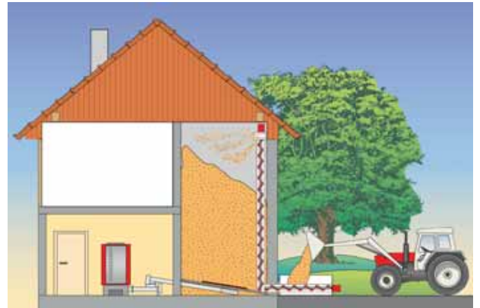
Großes Hackgutlager ebenerdig mit senkrechter Befüllschnecke.
