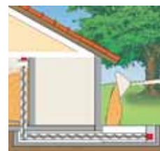
Befüllsystem mit Trog im Erdreich versenkt.
